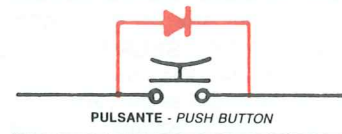
DIOLO IN DOTAZIONE ALLA ELETTROSERRATURA DIODE THE ELECTRIC LOCK IS SUPPLIED WITH
