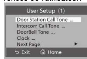
L'écran permet de sélectionner sonnerie différenciées pour l'appel provenant de la plaque extérieure (DOOR STATION CALL TONE) pour l'appel intercom (INTERCOM CALL TONE) et pour l'appel d'étage (DOORBELL TONE). En Sélectionnant une de ces voix apparaîtra la fenêtre de sélection de la mélodie.
