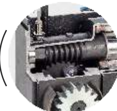
TANDWIJLEN VAN GEHARD STAAL IN OLIEBAD ENGRENAGES EN ACIER TREMPÉ À BAIN D'HUILE
